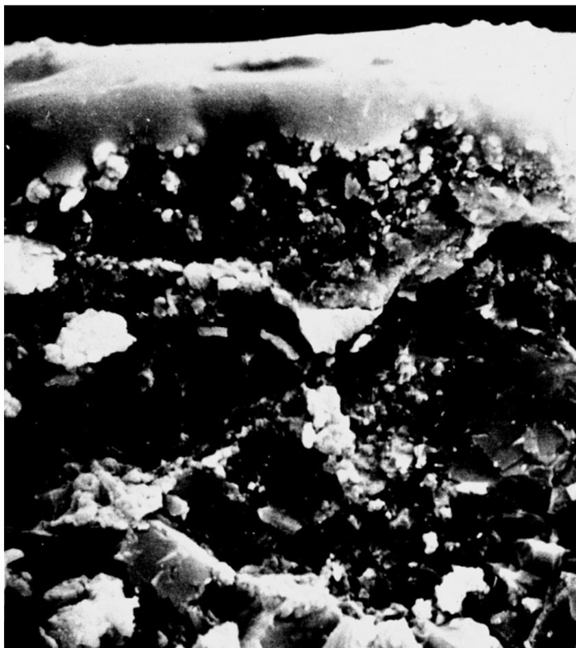
**Рис. 5.** Снимок поверхности зеркала скольжения с пленкой стекла, сделанный с использованием электронного сканирующего микроскопа. Толщина пленки, возникшей при контактно-фрикционном разогреве составляет 10-20 мкм
